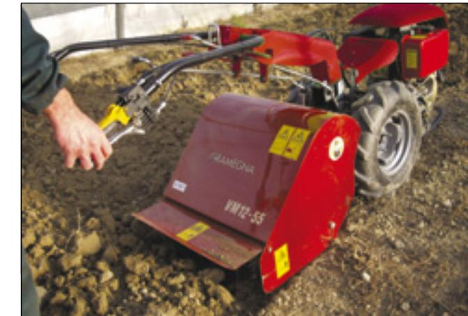
La regolazione delle slitte di appoggio e dell'ala posteriore permettono di variare facilmente la profondità ed il grado di affinamento del terreno. La VM12 assorbe poca potenza, non produce suola di lavorazione, lascia il terreno ben livellato e rispetta la struttura del terreno.
