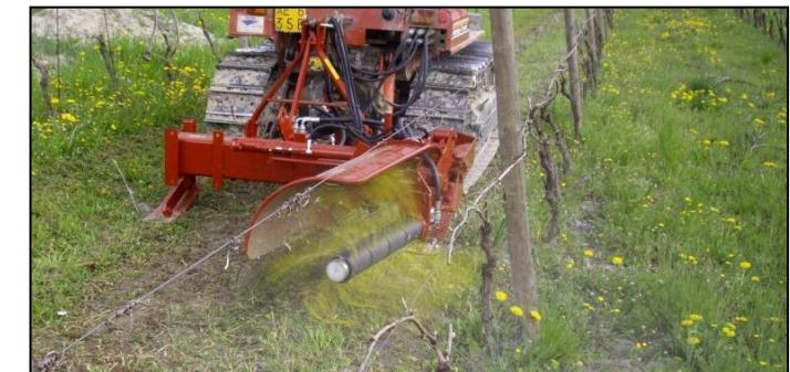
■ ■ I fili di nylon, oltre ad eliminare i polloni, eseguono un'ottima diserbatura, soprattutto attorno ai ceppi, rendendo superfluo il ricorso alla diserbatura chimica. La spollonatrice S92 è regolabile in altezza dal posto di guida ed è dotata di un sistema rapido per la sostituzione dei fili.
