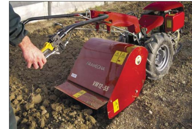
La regolazione delle slitte di appoggio e dell'ala posteriore permettono di variare facilmente la profondità ed il grado di affinamento del terreno. La VM assorbe poca potenza, non produce suola di lavorazione, lascia il terreno ben livellato e rispetta la struttura del terreno.
