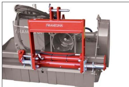
ATTACCO A TRE PUNTI SPOSTABILE IDRAULICO
