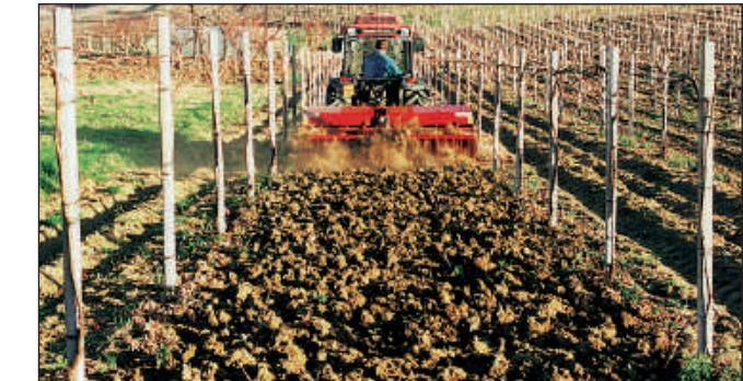
La Serie 30X è una vangatrice professionale che offre il massimo livello di qualità, robustezza ed affidabilità. È dotata di cuscinetti conici in tutti gli snodi superiori e biellismi di sezione maggiorata. Cambio a leva, ruote di profondità, griglia posteriore e altri accessori possono essere richiesti per adeguare la macchina alle proprie esigenze. Gli snodi inferiori sono dotati di un esclusivo sistema che non richiede alcun intervento di lubrificazione.
