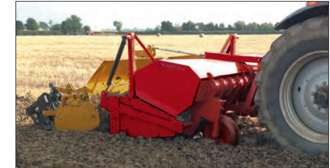
La presa di potenza posteriore e l'elevata robustezza del telaio permettono l'abbbinamento di macchine aggiuntive per la preparazione immediata del letto di semina.
