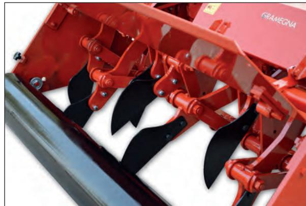
La macchina è dotata di lame in acciaio con profilo ricurvo in grado di fendere il terreno fino a 20-22 cm di profondità.
