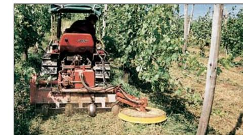
I dischi interceppi D68 e D85 sono azionati da un proprio impianto oleodinamico. Entrambi sono dotati di caratteristiche specifiche per effettuare una diserbatura perfetta anche negli interfilari di collina. Dal posto di guida è possibile comandare lo spostamento del disco, la sua sensibilità di movimento e bloccare lo stesso in posizione rientrata. A richiesta sono disponibili nella versione inclinabile comandabile dal posto di guida.
