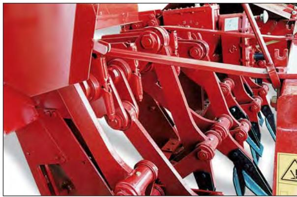
ITALY È dotata di cambio di velocità a leva e presa di potenza posteriore. Gli snodi inferiori sono progettati per non richiedere alcun intervento di lubrificazione da parte dell'operatore.
