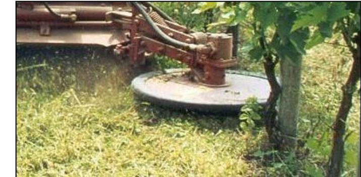
■ ■ Il disco falciante è montato su braccio oscillante a "parallelogramma" che gli consente di seguire perfettamente eventuali dislivelli del terreno. Dal posto di guida è possibile regolare la sensibilità di movimento e comandare il rientro manuale. A richiesta è possibile dotare il disco di inclinazione laterale comandabile dal posto di guida.
