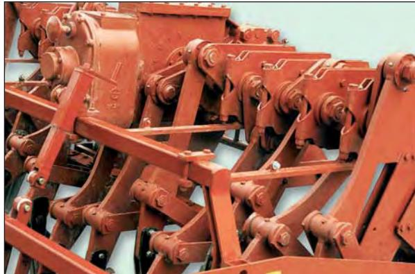
Struttura anti-intasamento di grande robustezza.
